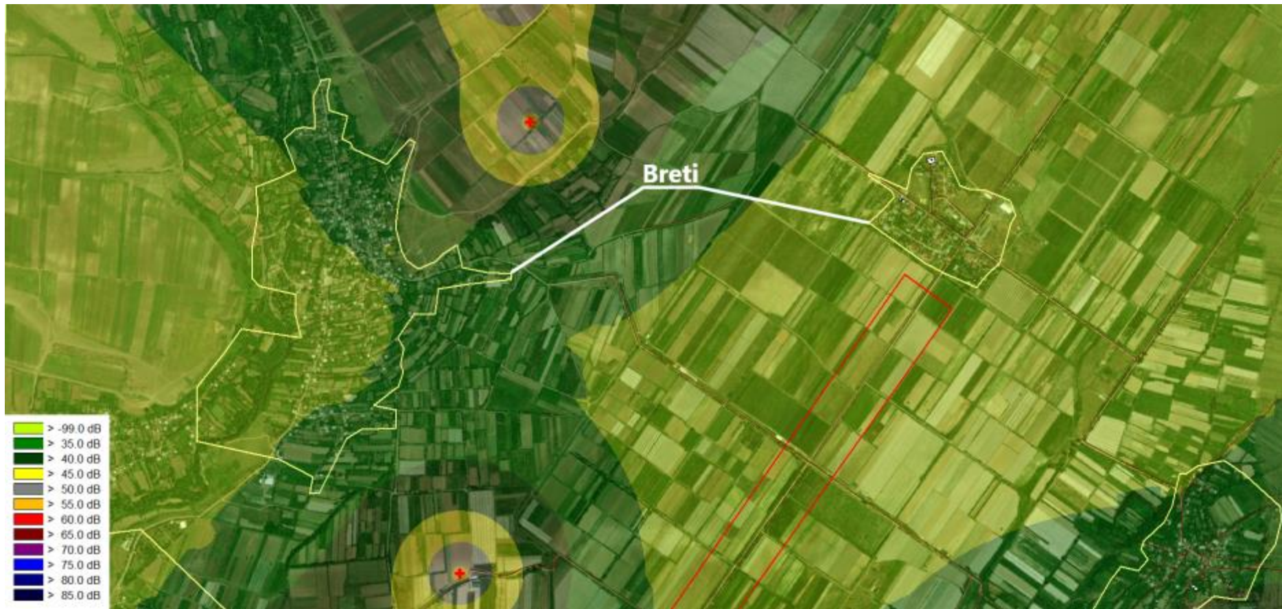
სურათი 6-10 ხმაურის გავრცელება სოფლების ბრეთი და ბრეთის მეურნეობა მახლობლად - ტურბინის სიმაღლე - 105 მ
