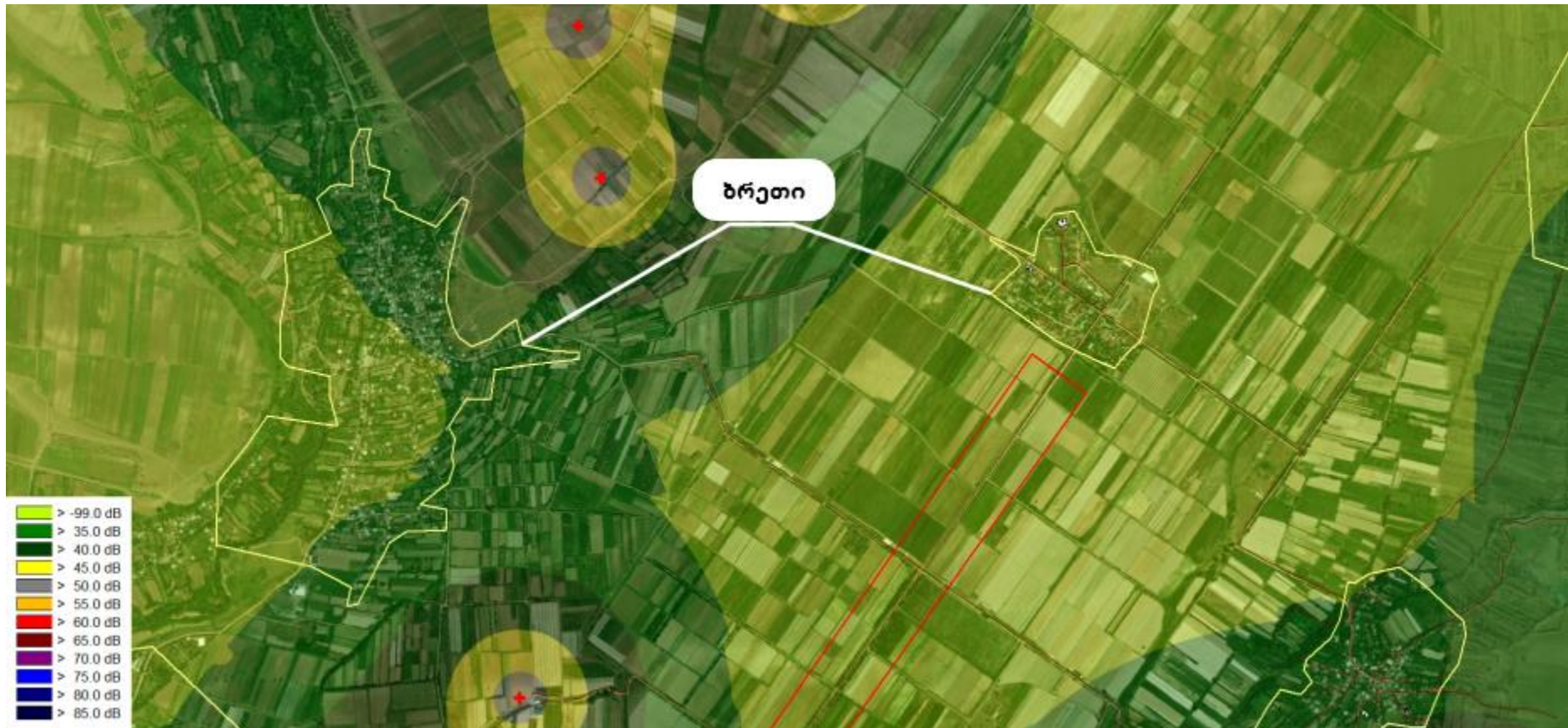
ნახაზი N9.16: ხმაურის გავრცელება სოფელ ბრეთის და ბრეთის მეურნეობის მიდამოებში - ტურბინის სიმაღლე - 150 მ.
